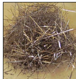
Fig. 2 Benzi de aliaj pe baza de NdFeB , preparate prin procedeul melt-spinning
